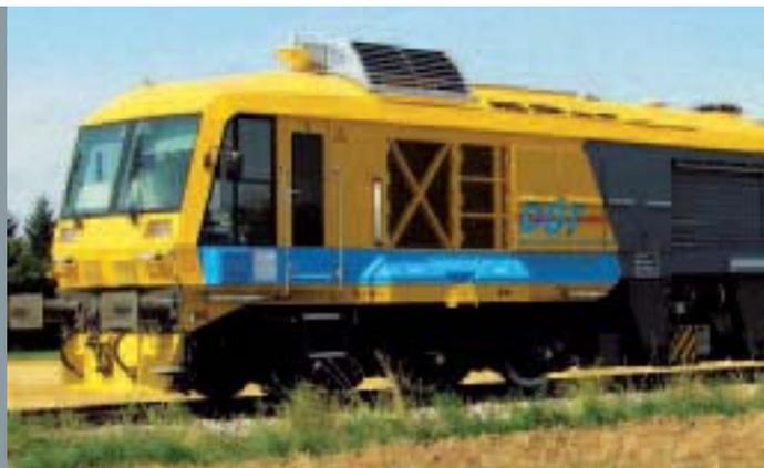
Der Schienenmess- und -schleifzug kontrolliert regelmäßig den Zustand des „Besonders überwachten Gleises“
